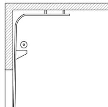
Рис. 3. Высокий монтаж с нижним расположением вала
