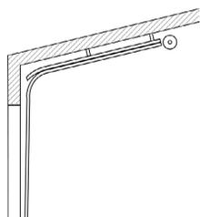
Рис. 10. Наклонный низкий монтаж
