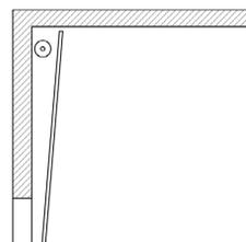
Рис. 5. Вертикальный монтаж с верхним расположением вала
