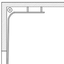
Рис. 4. Высокий монтаж с верхним расположением вала
