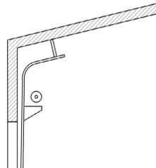
Рис. 9. Наклонный высокий монтаж с нижним расположением вала
