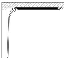
Рис. 2. Низкий монтаж
