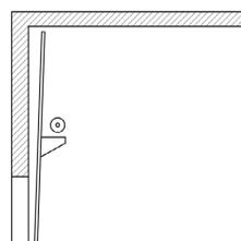
Рис. 6. Вертикальный монтаж с нижним расположением вала
