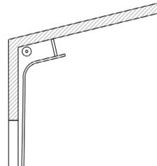
Рис. 8. Наклонный высокий монтаж с верхним расположением вала
